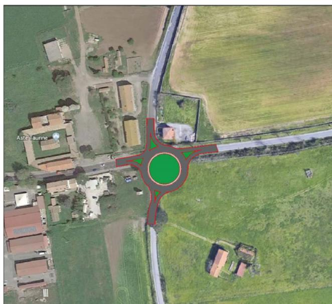
*Figura 6 – intersezione via Braccianese con Via Stazione di Cesano – proposta di rotatoria*
